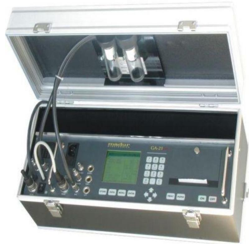
**Figura 3:** Analísador de infravermelho de bancada
