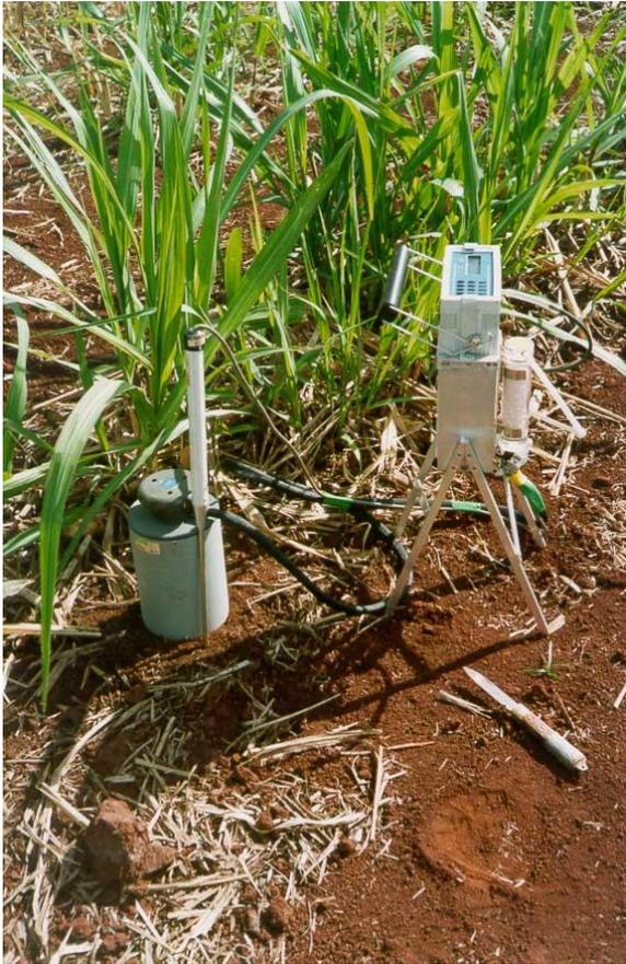
**Figura 2:** Analísador de infravermelho *in situ*
