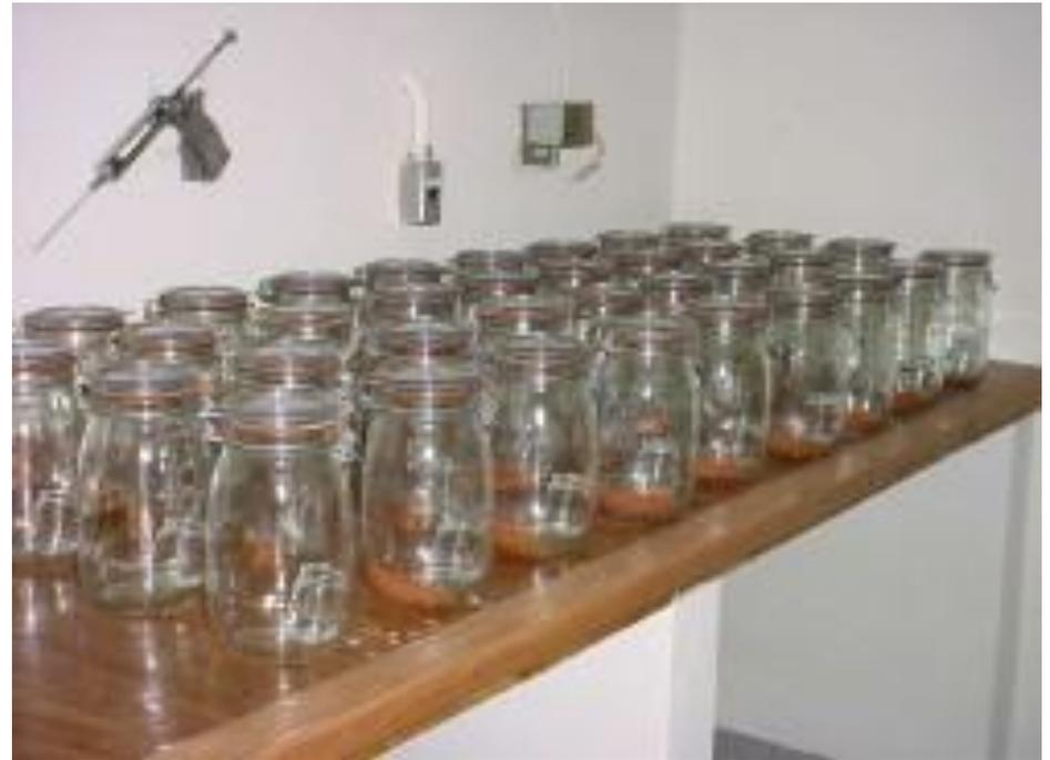
**Figura 1:** Câmara fechada para captura de CO<sub>2</sub>, e respirômetro de bancada
