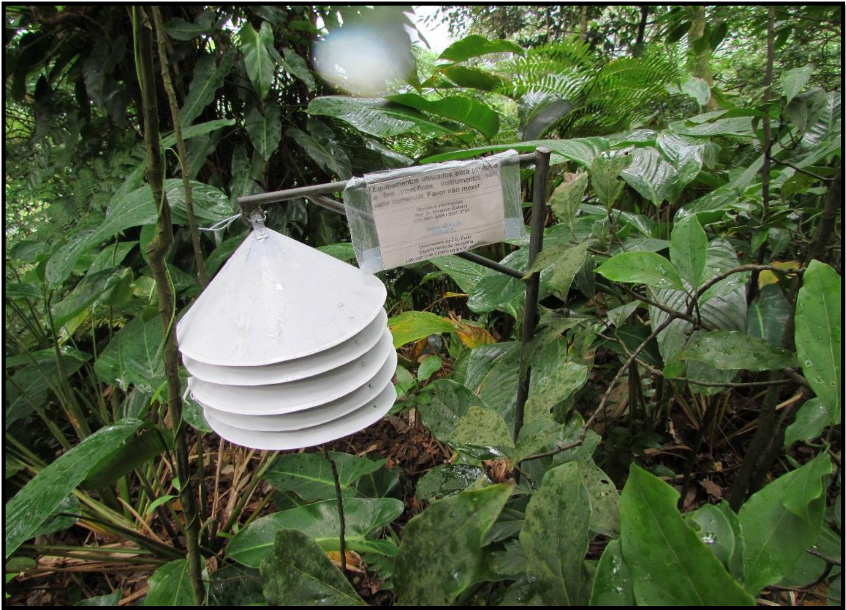
Foto: Mini abrigo meteorológico instalado. A autoria: Rodrigo Placoná, 15/04/2015
