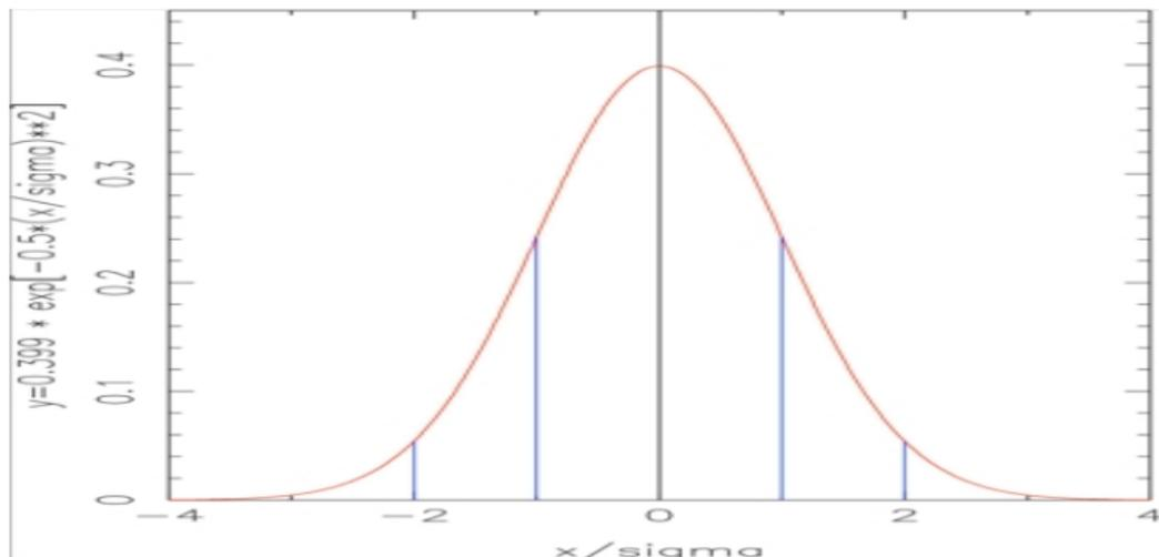
Distribuição Normal. A área total sob a curva é 1,00; dentro de  $\pm 1\sigma$  é (aproximadamente) 0.68; 0.95 dentro de  $\pm 2\sigma$  e 0.997 dentro de  $\pm 3\sigma$ .
