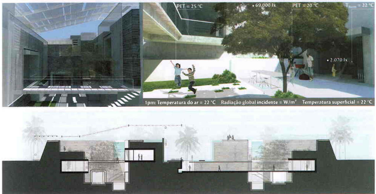
Fig. 1.20 Pesquisa de campo e simulações computacionais foram realizadas para avaliar o potencial de técnicas passivas e espaços de transição protegidos do Sol, como alternativas ao edifício climatizado por todo o ano, no clima quente e seco de Kuwait, de latitude 29° 22'N e longitude 47° 58'E Fonte: Dib (2013).
