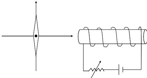
2) a) Um estudante liga uma bobina a uma fonte de corrente contínua (*DC Power Supply*). Ele observa que a bússola gira no sentido horário quando bobina é conectada conforme ilustrado na figura abaixo. Qual a direção do campo  $B$ , gerado pela bobina? Indique no centro da bobina do espaço da direita utilizando a notação  $\otimes$  (campo entrando na página) ou  $\odot$  (saindo da página).
