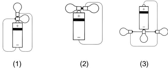
7) a. Quais dos diagramas de circuitos abaixo podem ser utilizados para representar o mesmo circuito físico; isto é, quais circuitos têm as mesmas conexões elétricas? Para dar esta decisão você pode achar útil redesenhar alguns dos circuitos.
