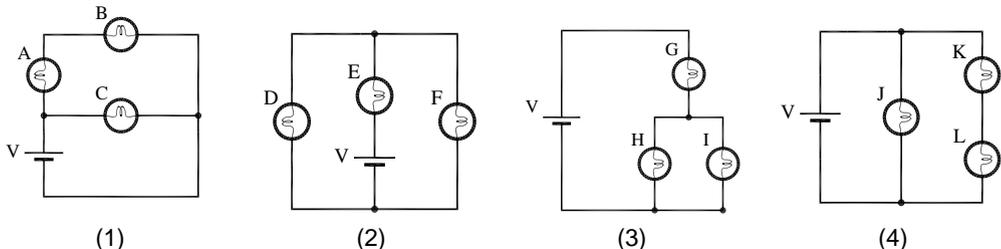
b. Quantos circuitos diferentes estão representados pelos diagramas acima? Em cada caso identifique as ligações em série e paralelo das lâmpadas e circuitos de lâmpadas.
