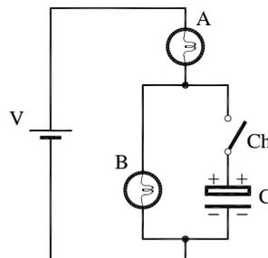
8. Faça um prognóstico detalhado (de modo análogo ao feito no exercício 7) o comportamento do circuito ao lado, supondo que inicialmente os dois capacitores estejam descarregados e que as capacitâncias sejam iguais ( $C_1 = C_2 = C$ ).
