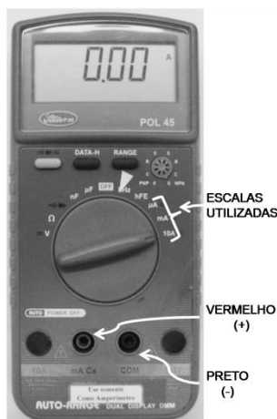
Figura 1.11 - Multímetro a ser usado como Amperímetro
