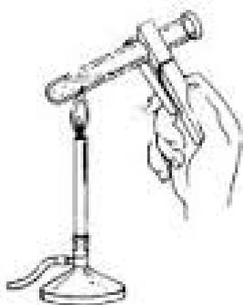
O tubo é seguro próximo de sua boca, pela pinça de madeira e agita-se brandamente, para evitar superaquecimento do líquido. Assim, tubos de ensaio, ao serem aquecidos, devem ser ligeiramente inclinados e seguros através de uma pinça, conforme mostrado na figura, aquecendo-o na superfície do líquido (e não no fundo) e agitando-o, vez por outra, fora da chama. Mantenha a boca do tubo em direção oposta do seu rosto e certifique-se de que nenhum colega será atingido caso seja expelido algum líquido.
