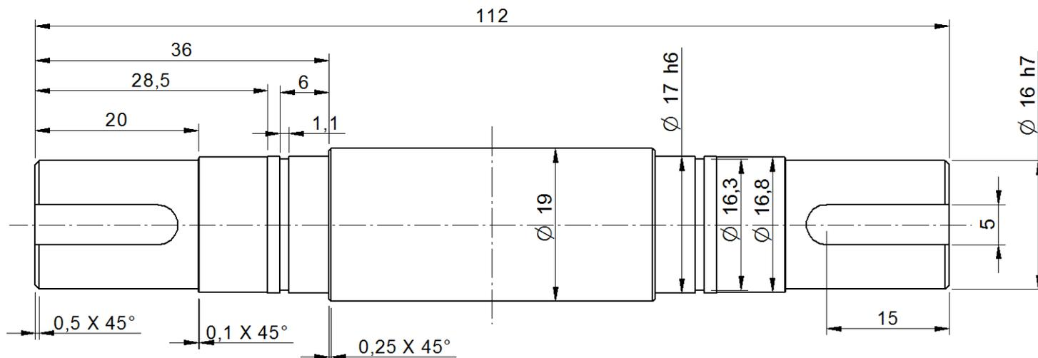
Nos escalonamentos do eixo (diâmetro) devem possuir raios de arredondamento ou canal de alívio para saída de rebolo.
