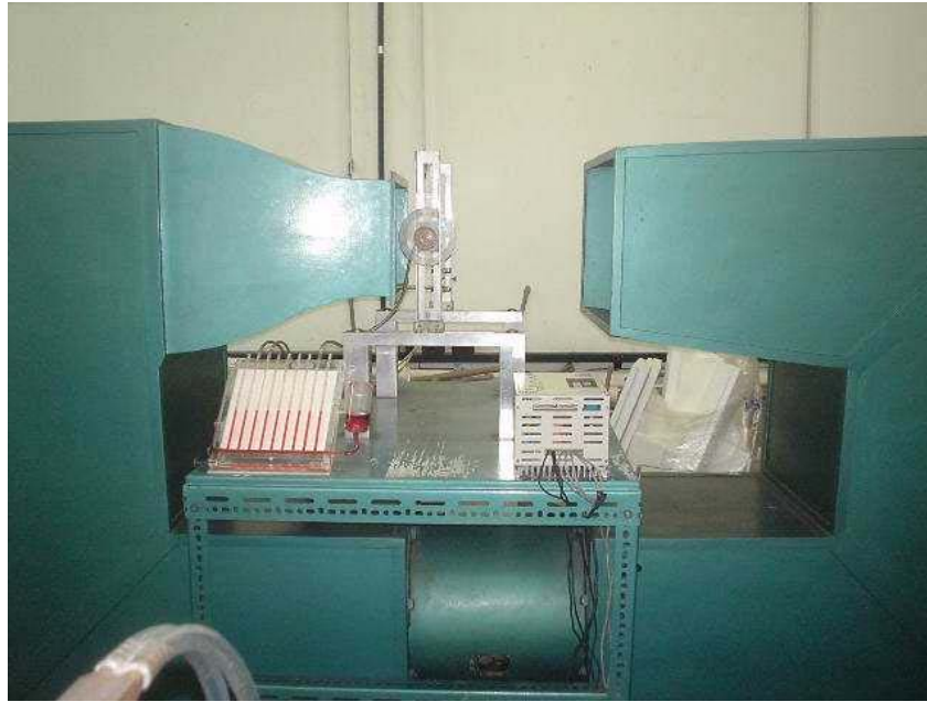
FIGURA 6 – Vista geral do túnel de vento. Cilindro na seção de testes (Carmo & Arienzo Jr, 2004).
