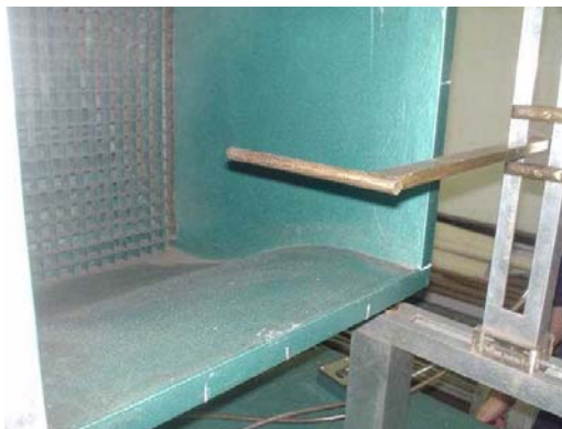
FIGURA 8 – Tubo de Pitot estático (Carmo & Arienzo Jr, 2004).
