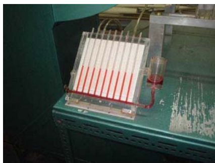
FIGURA 9 – Manômetro múltiplo (Carmo & Arienzo Jr, 2004).
