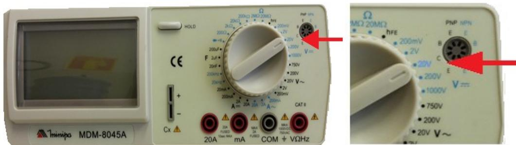
*Modo de medida Potencial Elétrico (20V  $\overline{\dots}$ )*
