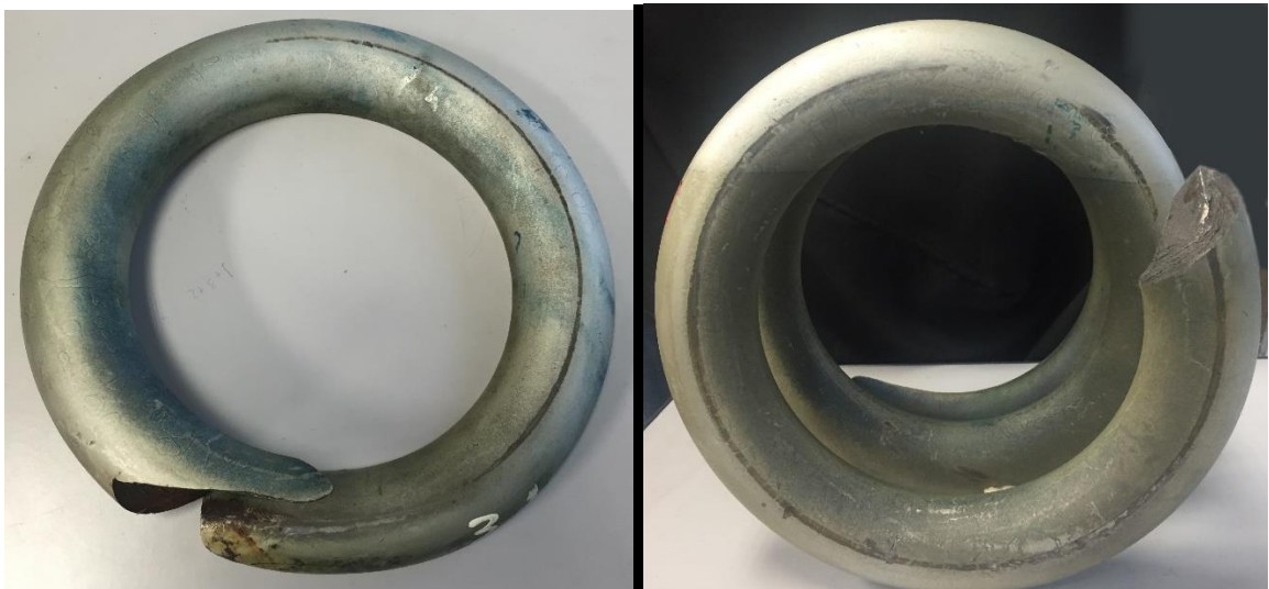
Figura 1 – Pedaços de duas molas rompidas em serviço #3.1 e #1.1, trazidas para análise.
