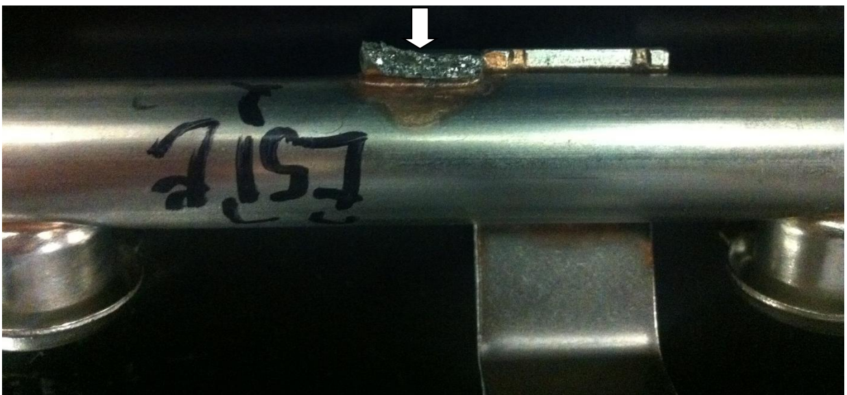
Figura 2 – Haste de aço inoxidável ferrítico AISI 430 fraturada durante operação de calibração.
