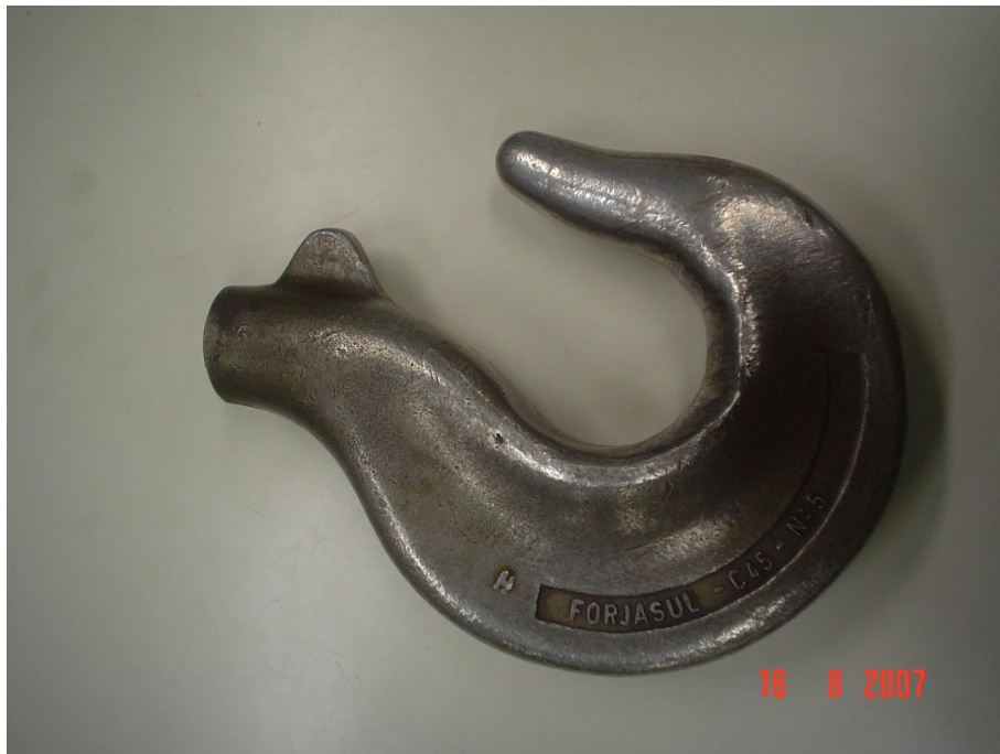
Figura 1 – Gancho de aço C45 forjado.
