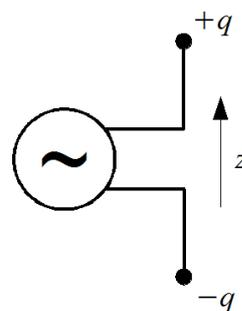
Nós podemos visualizar esta oscilação das cargas como se elas estivessem oscilando entre os terminais da antena (ao longo do eixo) de acordo com
