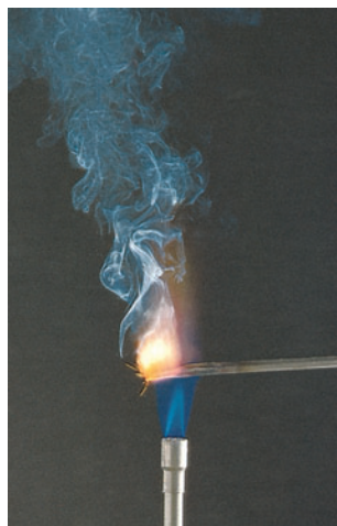
FIGURA 1.51 Quando óxido de estanho(II) é aquecido ao ar, ele se torna incandescente porque forma óxido de estanho(IV). Mesmo sem ser aquecido, ele fica em brasa e pode arder.
