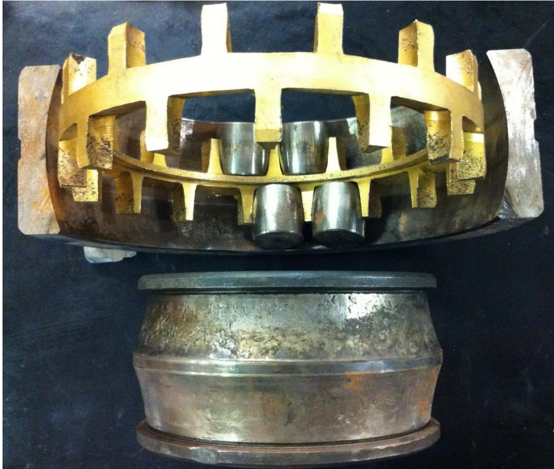
Figura 2 – Rolamento cortado e desmontado para visualização das superfícies de desgaste do anel interno e do anel externo.
