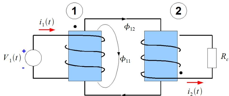
Como num esquema de circuitos fica difícil especificar o sentido dos enrolamentos, se utiliza a convenção de pontos indicada a seguir. Considerando a corrente no primário entrando pelo terminal marcado pelo ponto, a tensão induzida no secundário é positiva no terminal marcado com o ponto
