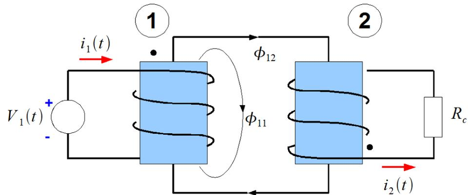
Se a corrente aumenta no circuito ①, o fluxo  $\phi_{12}$  aumenta e a corrente no circuito ② tem que sair do terminal marcado com o ponto, para que o fluxo por ele produzido se oponha ao aumento de fluxo no secundário.
