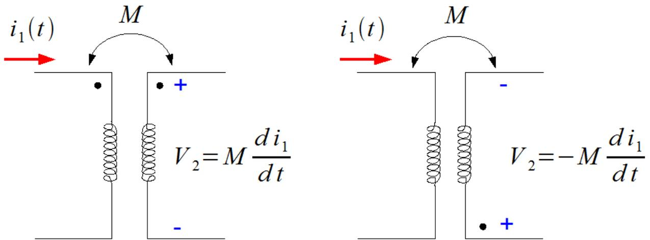
Então, quando escrevermos as equações de circuito para dois circuitos acoplados, a tensão devido ao acoplamento pode ser positiva ou negativa. Por exemplo, consideremos o circuito simples a seguir
