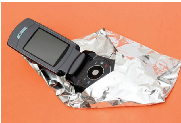
Fig. 15 – Bloqueando a onda: celular enrolado no papel alumínio.
