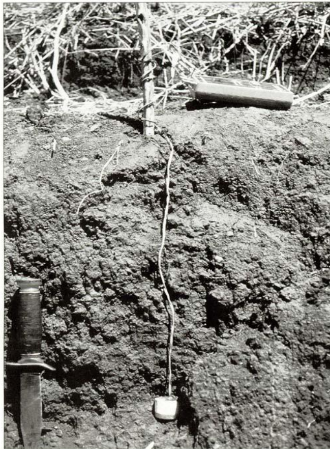
FIGURA 2.18 Corte longitudinal de um solo, mostrando um bloco de resistência elétrica, confeccionado com gesso, localizado à aproximadamente 45 cm abaixo da superfície. Fios conectam os blocos a um medidor de resistência elétrica. Os blocos podem ser enterrados à diferentes profundidades na zona radicular das culturas (Foto cortesia de R. Weil).
