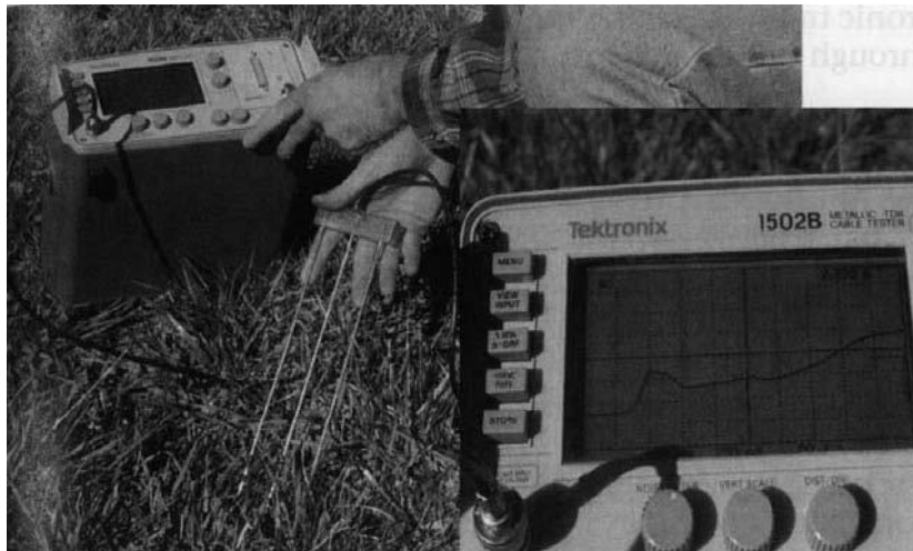
FIGURA 2.15 Medida do conteúdo de água no solo utilizando TDR. O instrumento eletrônico envia um pulso eletromagnético de energia por duas barras paralelas de metal, que o operador está empurrando no interior do solo. O TDR faz leituras precisas, da ordem de picossegundos, na velocidade da qual os impulsos se deslocam nas barras, a qual é influenciada pela natureza do solo. Microprocessadores analisam os padrões de onda gerados e calculam a constante dielétrica do solo. Como a constante dielétrica do solo é influenciada principalmente pelo seu conteúdo de água, o instrumento pode precisamente converter estas medidas em conteúdo volumétrico de água no solo (foto cortesia de Soilmoisture Equipment Corporation, Goleta, Califórnia).
