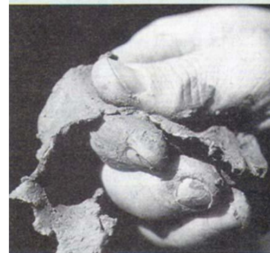
FIGURA 1.7 Método do Tato para determinação da classe textural do solo. Uma amostra de solo úmido é esfregada entre o dedo indicador e o polegar, e amassada para formar um fio. (Topo) O “fio” curto, mostra aparência não coesiva, arenoso de textura franco-arenosa com cerca de 15% de argila. (Centro) O “fio” uniforme de aparência friável é característico de textura franco-siltosa. (Baixo) Maciez, aparência lustrosa e “fios” longos e flexíveis são característicos de textura argilosa. (Fotos cortesia de R. Weil)
