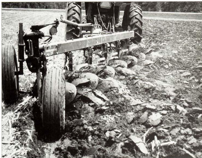
FIGURA 1.35 A ação exercida pelo arado de aiveca se restringe às camadas superiores do solo (15 a 20 cm) compactando as camadas mais profundas. Este efeito ocorre, pelo fato do implemento apoiar-se sobre as camadas inferiores para revolver a camada arável. Isto pode ser facilmente compreendido se imaginarmos que ao levantarmos um peso nossos pés pressionam o chão abaixo (Foto cortesia de R. Weil).
