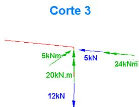
Na seção transversal do corte 3, os esforços são a força normal 12 kN na direção z e o momento torçor de 20 kNm e o momento fletor de 24 kNm da seção transversal junto ao corte 1 (as forças normais e momentos são reduzidos/transferidos sem acréscimos). Além disso, a força de 5kN na direção y ao ser reduzido/transferido do corte 1 para o corte 3 acrescenta o momento de  $5\text{kN} \times 1\text{m} = 5\text{kNm}$  em torno do eixo x.
