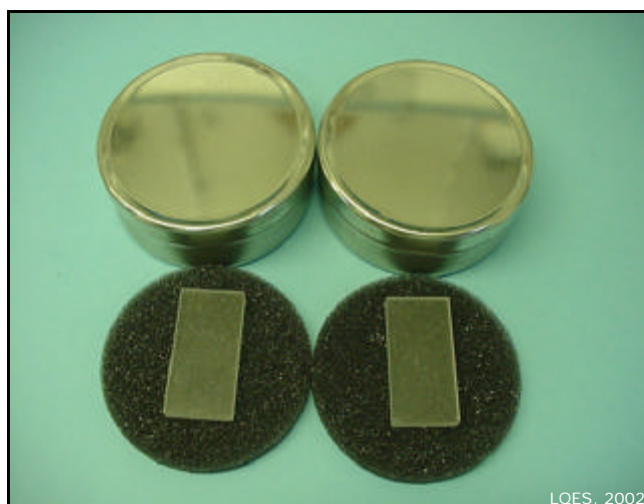
Figura 1. Janelas de haletos alcalinos e suas respectivas embalagens.
