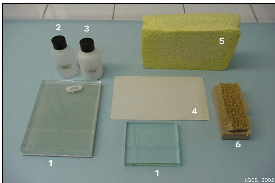
Figura 2. Componentes do Kit de Polimento P/N 400 Specac, contendo: placas de vidro de alta planicidade [1]; frasco de polietileno para o etanol [2]; frasco de polietileno para o pó de polimento (óxido de cério)[3]; tecido afanelado para polimento [4]; esponja para limpeza das placas de vidro [5] e escova para limpeza[6].
