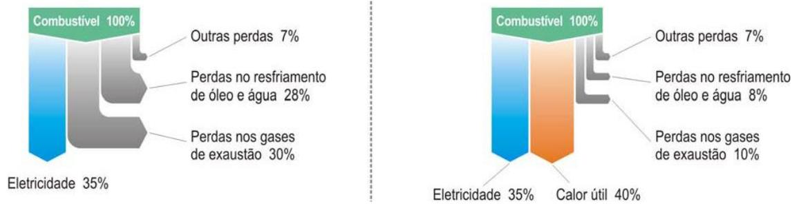
Balço térmico típico de planta de geração pura utilizando motor alternativo e balço térmico de uma planta semelhante, com sistema de cogeração agregado.
