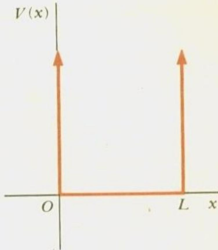
**Fig. 6.1** Energia potencial de poço quadrado infinito. Para  $0 < x < L$ , a energia potencial  $V(x)$  é nula. Fora dessa região,  $V(x)$  é infinita. A partícula está confinada à região no poço  $0 < x < L$ .
