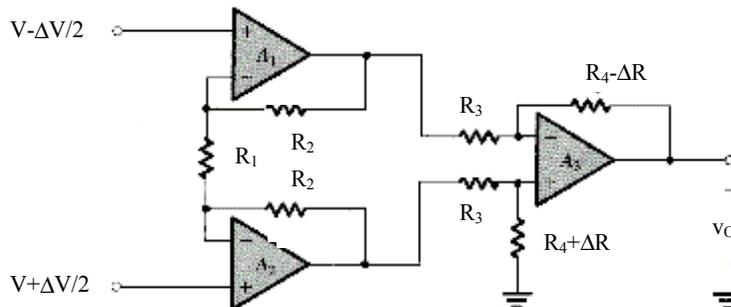
(a) Considerando-se todos os componentes ideais, e no caso de termos resistores precisos ( $\Delta R = 0$ ), deduza a expressão do ganho diferencial  $A_d = v_o/\Delta V$ . (b) Na condição do item (a), calcule  $A_d$  para  $R_1 = 10 \text{ k}\Omega$  e  $R_2 = R_3 = R_4 = 100 \text{ k}\Omega$  (c) Considerando-se que os resistores  $R_4$  ( $\Delta R \neq 0$ ) estejam desbalanceados, obtenha a expressão de  $v_o$  do tipo:  $v_o = A_d \Delta V + A_c V$ .
