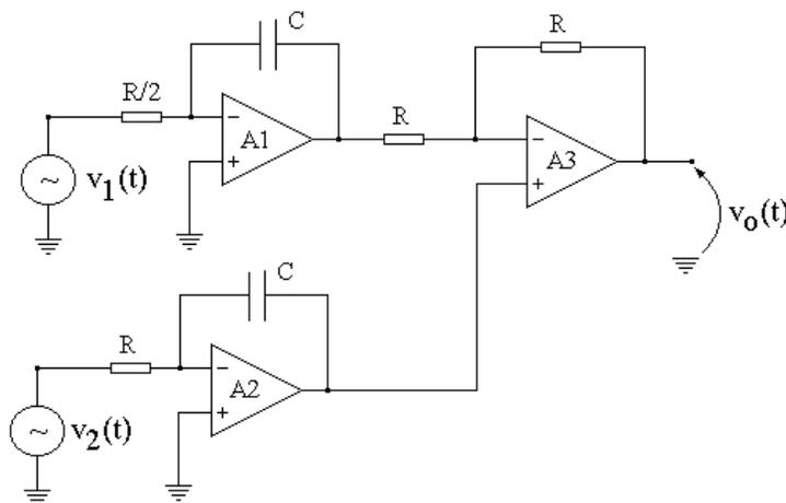
(a) Determine a expressão de  $v_o(t)$  como função dos sinais de entrada  $v_1(t)$  e  $v_2(t)$ . (b) Redesenhe o circuito anterior com apenas um amplificador operacional e apenas dois capacitores. Não há limite quanto ao número de resistores a serem escolhidos. Por outro lado, o circuito redesenhado deve ter a mesma relação funcional entre o sinal de saída  $v_o(t)$  e os sinais de entrada  $v_1(t)$  e  $v_2(t)$  do item (a).
