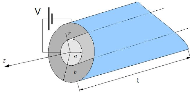
Como a configuração tem simetria cilíndrica, naturalmente  $\partial\phi/\partial\theta = 0$ . Por outro lado, se o cabo for bastante longo, isto é,  $\ell \gg b$ , podemos desprezar a variação do potencial com a coordenada longitudinal  $\ell$ ; então  $\phi = \phi(r)$  e
