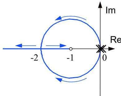
Comparando este diagrama com o do Exemplo 1, notamos que a presença do zero produziu uma "atração" do L.G.R. para próximo do ponto -1.
