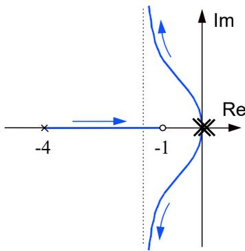
Comparando este diagrama com aquele obtido no Exemplo 2, notamos que a presença do polo adicional em  $s = -4$  teve, dentre outros, o efeito de "repelir" o L.G.R. para longe de si.
