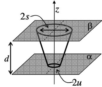
a) (1,0) Determine a resistência desses cones em função da distância  $d$  entre as trilhas e os raios  $u$  e  $s$ . Qual seria o valor da resistência caso o cone termine num vértice agudo ( $u=0$ ).
