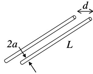
c) (0,5) Estime a capacitância das duas trilhas com comprimento  $L \gg d$  como ilustradas no item b). Faça as aproximações que julgar conveniente. (sugestão: suponha um dos condutores com carga  $Q$ . Calcule o campo e o potencial para  $a < r < d$  devido a esse condutor. Obtenha a capacitância quando  $r=d$ . Note que a solução é idêntica à do capacitor cilíndrico.)
