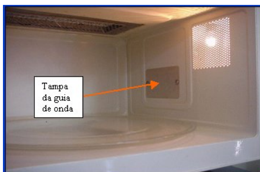
Interior do aparelho e a saída das microondas
