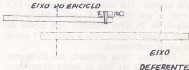
Adapte uma fonte luminosa (pilha, lâmpada e suporte) a um extremo do braço epiciclo e contrabalance o outro extremo do braço, por exemplo, com outra fonte igual mas apagada. Se usar uma velocidade de rotação relativamente elevada numa sala às escuras, poderá juntamente com outros observadores ver a fonte de luz mover-se num epiciclo.
