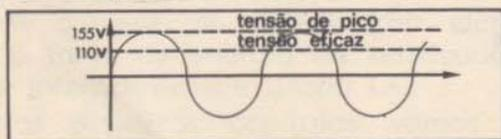
R15 — O aparelho só funciona em uma rede de corrente alternada de 110V e cuja a frequência pode tomar valores entre 50Hz — 60Hz. A corrente de funcionamento para esta tensão é de 0,90A e a potência dissipada é de 80 watts (vide capítulo 8).
