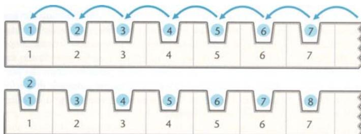
O esquema acima representa um chip de memória infinitamente longo. Se todos os elétrons (coloridos), com exceção do primeiro, forem deslocados um dispositivo para a esquerda, o resultado será um elétron excedente no primeiro dispositivo. As lacunas deixadas pelos elétrons removidos desaparecem no infinito, o que contradiz a lei de conservação de energia e de carga
