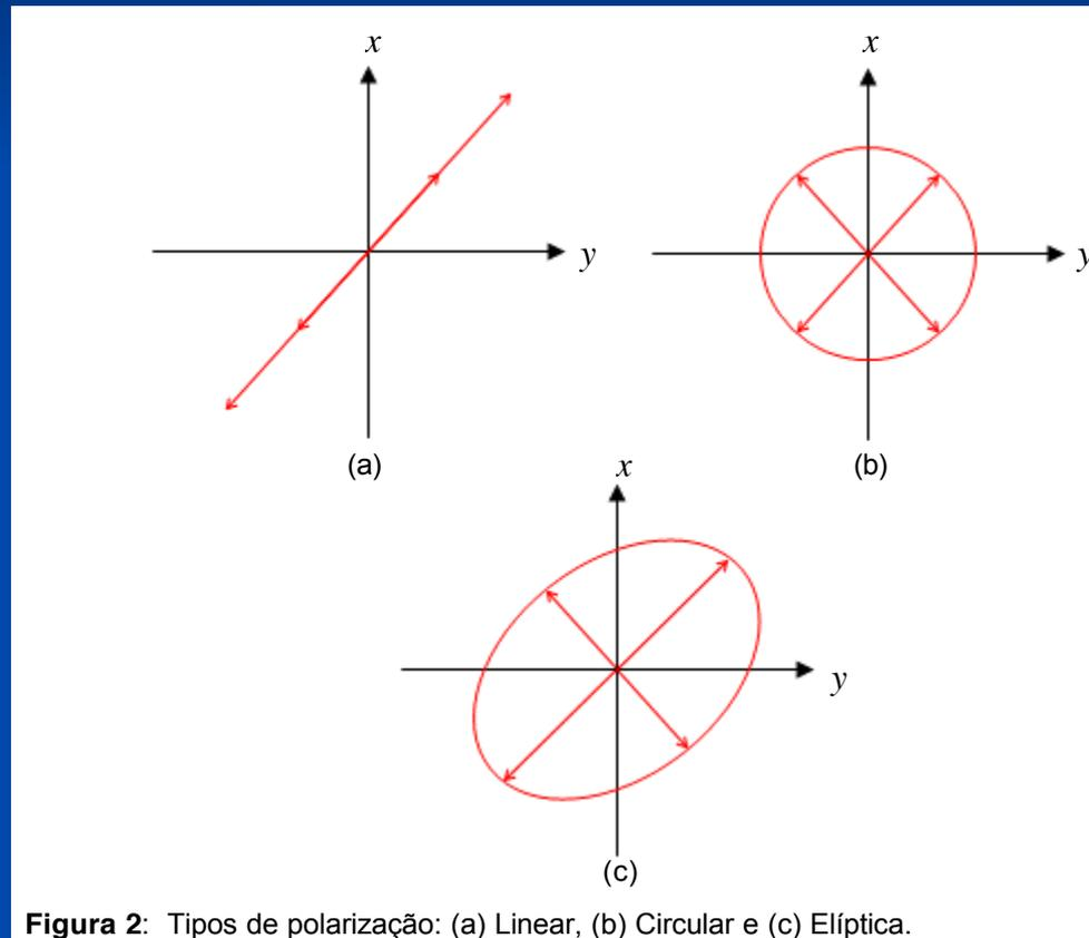
**Figura 2:** Tipos de polarização: (a) Linear, (b) Circular e (c) Elíptica.
