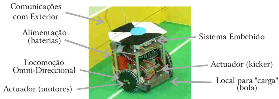
Figura 7.1 Descrição geral do robot desenvolvido para liga F180
