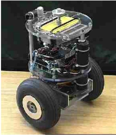
Figura 2.9 “nBot” Robot que se equilibra em duas rodas [7]
