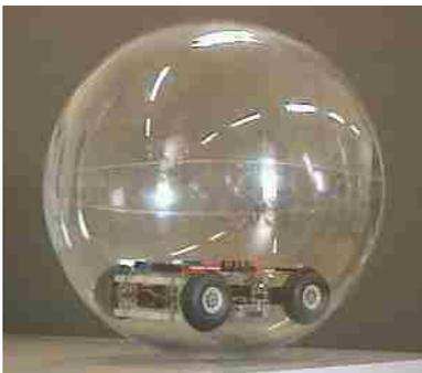
Figura 2.17 Robot esférico [19]
