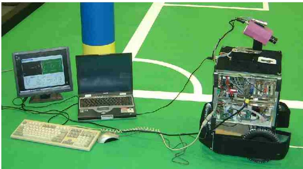
*Figura 7.7 Robot 5dpo-2000 versão modificada para movimento omni-direccional a ser configurado (foto no RoboCup 2003, Pádua, Itália)*
