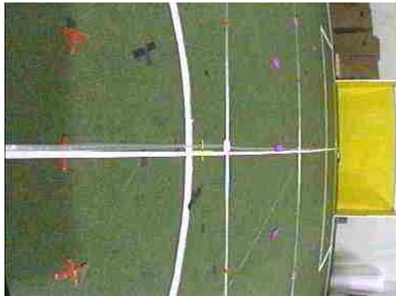
Figura 8.16 Imagem da câmara dentro do robot durante a sua calibração (capturada através de um utilitário de desktop remoto)
