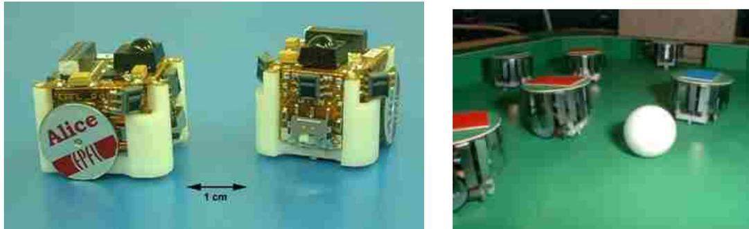
Figura 2.19 Robots “Alice”: à esquerda foto do robot (com escala); à direita estes robôs a jogarem futebol 3 contra 3 [24]
