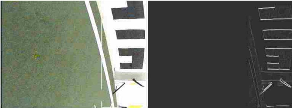
Figura 8.25 Imagem no robot à esquerda e derivada na luminância à direita (imagem capturada através de desktop remoto)
