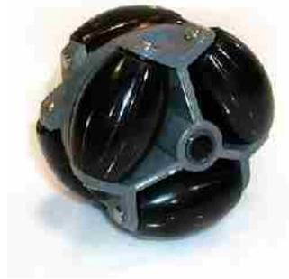
Figura 2.14 À esquerda está um robot “protótipo rápido” com rodas omni-direccionais e à direita uma roda omni-direccional ampliada [13]
