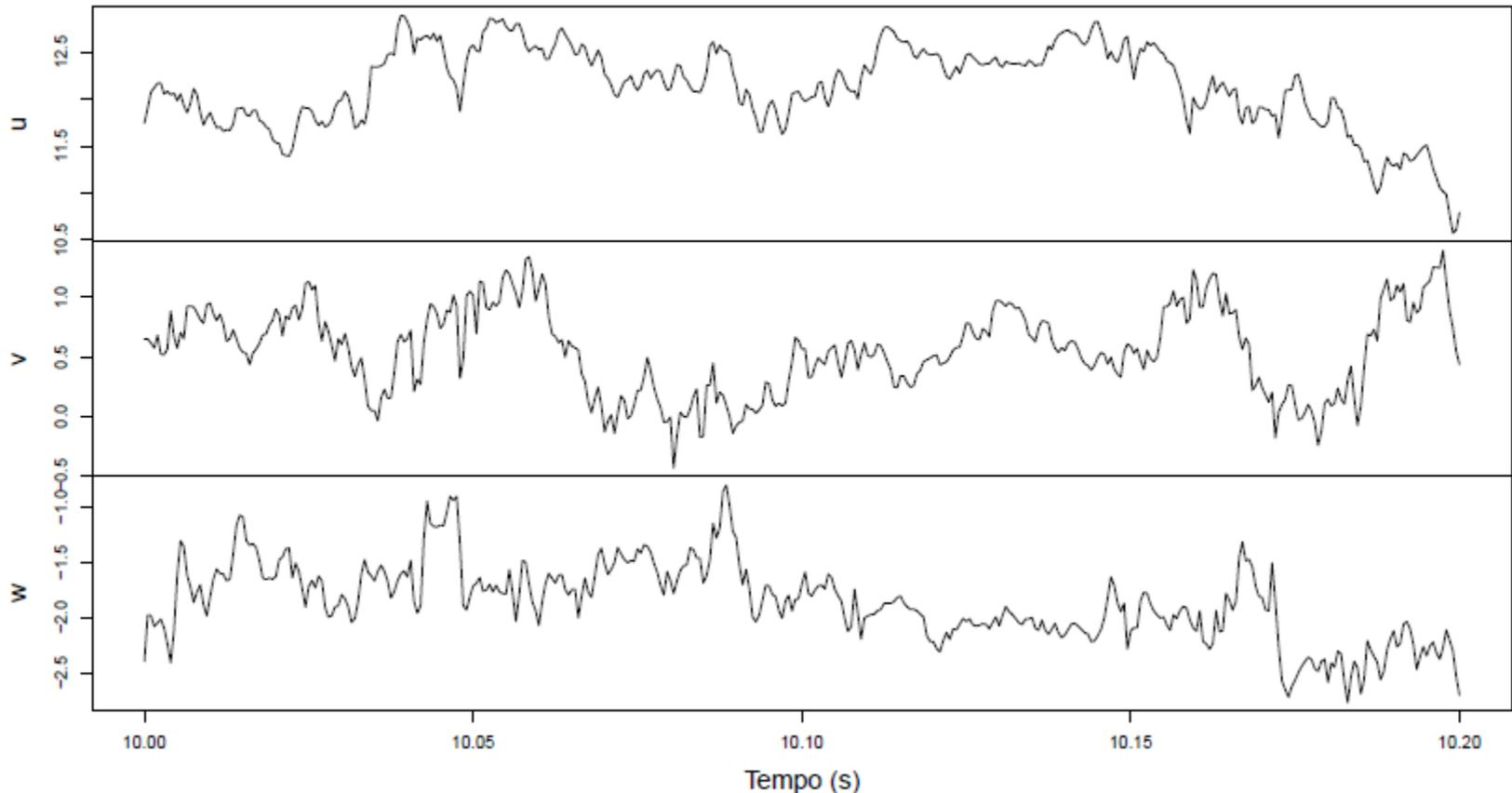
Os gráficos acima mostram a complexidade do sinal da velocidade em um ponto de um escoamento qualquer. São mostradas as três componentes da velocidade, U, V e W. Observe que U está ao redor de 12m/s, enquanto V está ao redor de 0,5 m/s e W de -1,5m/s.
