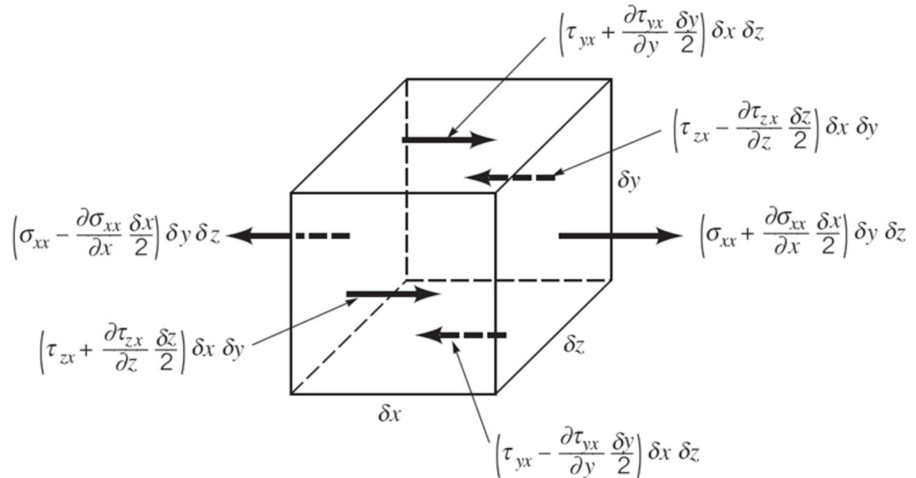
Forças de superfície decorrentes de tensões normais e tangenciais atuando em elemento de fluido na **direção x**. Forças de campo não aparecem na figura.
