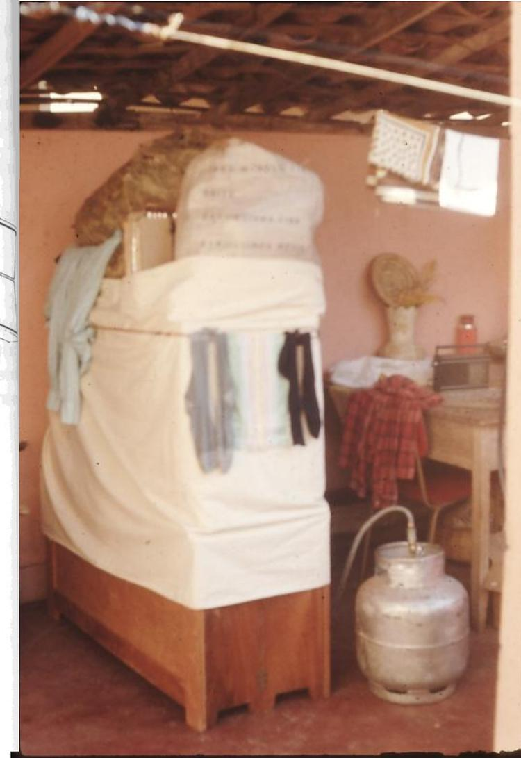
Fig. 9 — ESTUFA DE CAMPO. A. lateral da base da estufa. B. base de estufa vista de cima e mostrando os 2 fogareiros. C. como pode ser dobrada a base de estufa para facilitar o seu transporte. D. caixão sobre a base da estufa. E. estufa completa. Note a maneira de apertar as coletas com tábuas.
