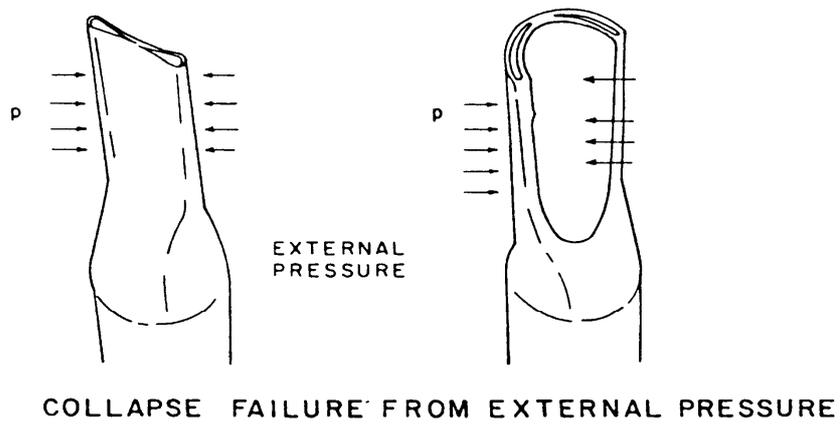
Pressão de colapso é afetada por tensão axial
