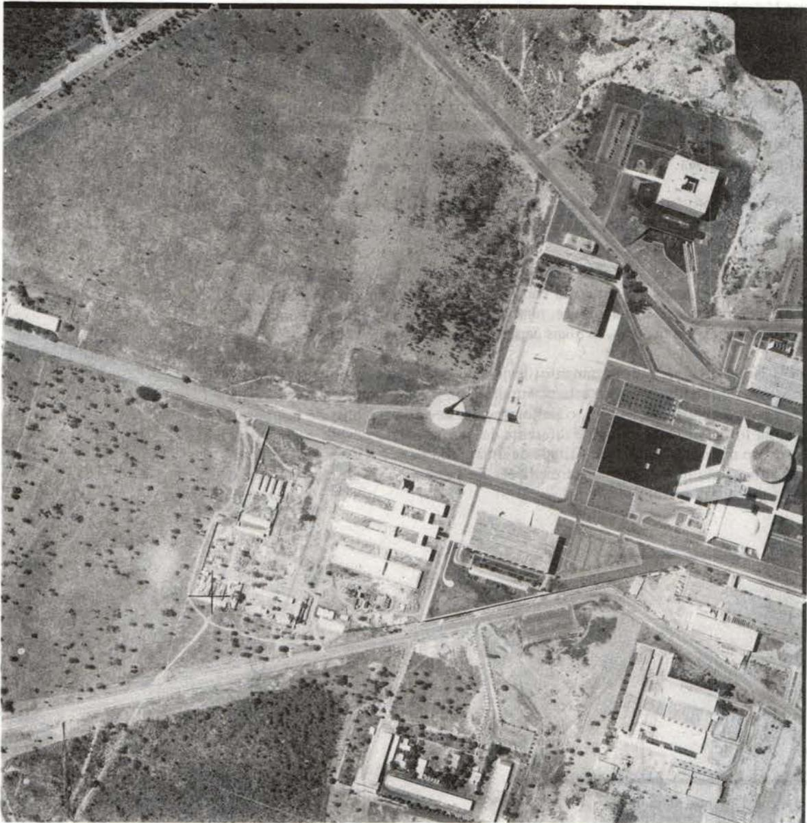
**FIGURA 7.8** – Deslocamento radial devido ao relevo e à altura. (Número da foto: 7737; data: 15-11-1977) (com ponto principal marcado) (Cortesia da CODEPLAN)
