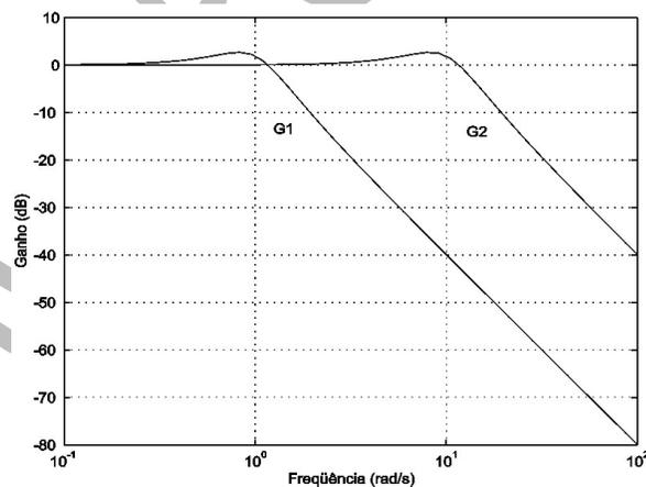
Observa-se claramente que a frequência de corte de  $G_1(s)$  é de aproximadamente 1,2 rad/s, ao passo que a de  $G_2(s)$  está em torno de 12 rad/s. Isto significa que  $G_2(s)$  é capaz de responder mais rapidamente do que  $G_1(s)$ . Para comprovar este fato, a figura abaixo contém as respostas a degrau de ambos os sistemas.
