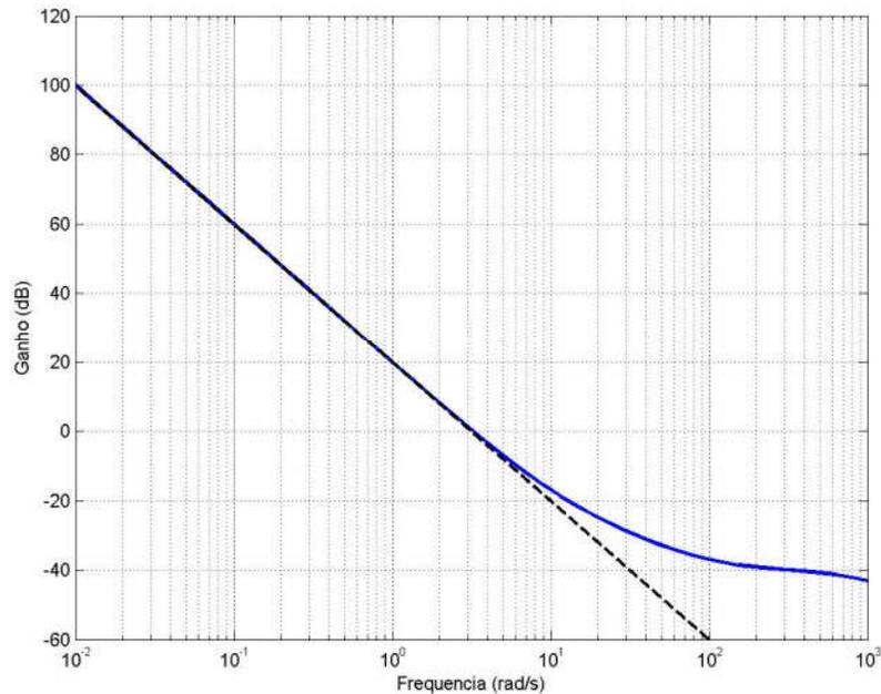
Observando-se o diagrama, nota-se que a declividade do gráfico em baixas frequências é de  $-40$  dB/dec. Portanto, trata-se de um sistema do Tipo 2. Além disso, da aproximação em baixas frequências (reta tracejada), obtém-se que
