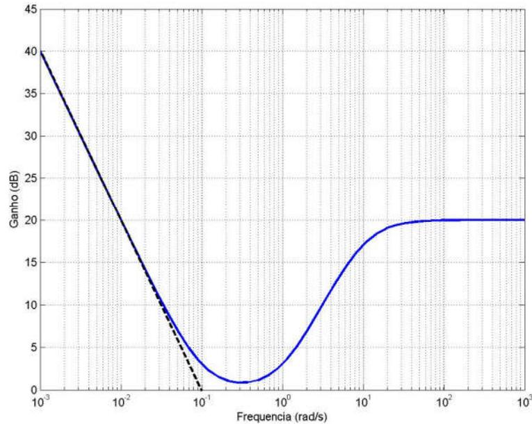
Observando-se o diagrama, nota-se que a declividade do gráfico em baixas frequências é de  $-20$  dB/dec. Portanto, trata-se de um sistema do Tipo 1. Além disso, nota-se que a aproximação em baixas frequências (reta tracejada) cruza a linha de  $0$  dB em  $\bar{\omega} = 0,1$  rad/s e, com base em ii.a), conclui-se que
