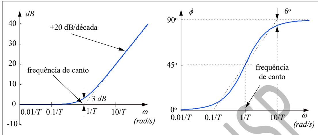
Para o caso de polos (zeros) de multiplicidade  $N$ , a frequência de canto continua sendo  $\omega = 1/T$ . As assíntotas do gráfico são, para baixas frequências, a reta  $0 \text{ dB}$  e, para altas frequências, a reta que passa pelo ponto  $(1/T, 0 \text{ dB})$  e tem declividade  $-20N \text{ dB/década}$  ( $+20N \text{ dB/década}$ ).
