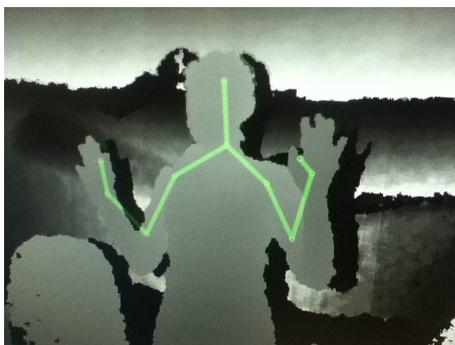
Figura 7: Imagem de profundidade e esqueleto capturada pelo Kinect.
