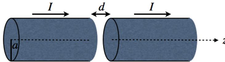
Esse pedacinho que falta no fio (o “intervalo” de largura  $d$ ) não altera a corrente, de forma que você pode pensar nas faces opostas do fio, em cada lado do intervalo, como um capacitor de placas paralelas. Considere que a corrente é nula inicialmente, e começa a fluir na direção  $z$  no instante  $t = 0$ .
