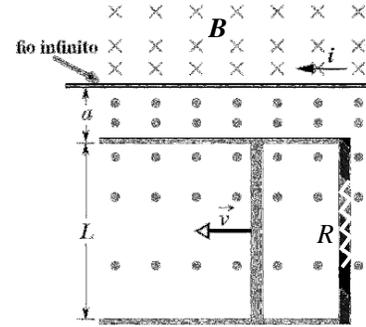
Um fio horizontal *infinito* está paralelo aos dois condutores e a uma distância  $a$  do condutor mais próximo. Pelo fio passa uma corrente  $i=i_0$  inicialmente constante, como indicado na figura.
