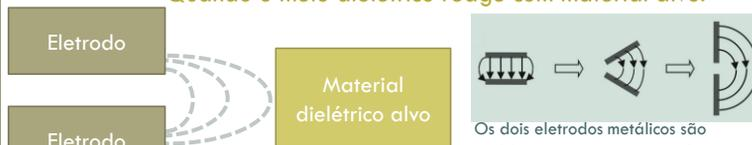
Sensor depende do material do alvo para interferir com o campo elétrico do sensor para mudar sua capacitância
