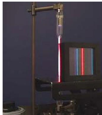
Figura 5.3: Descarga e coleta da luz de uma ampola gasosa.
