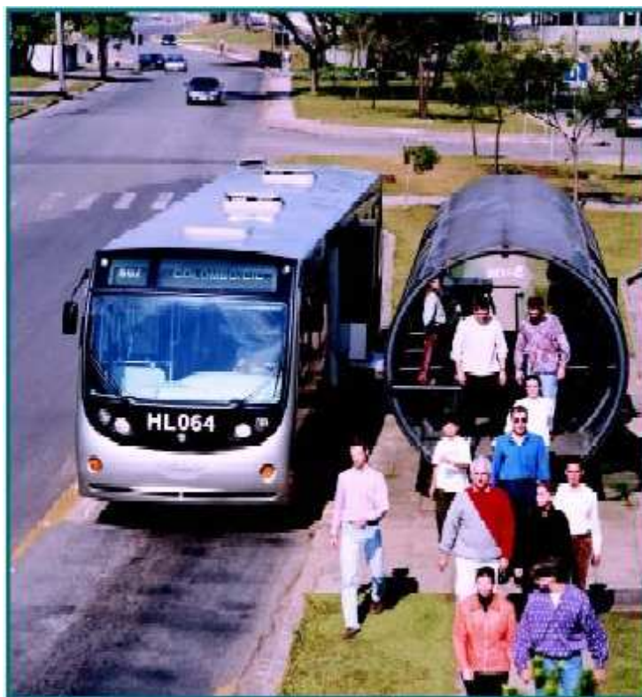
Figura 15 – Embarque realizado em plataformas no nível do piso dos veículos.
