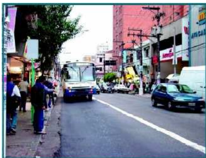
Figura 1 – Faixa exclusiva sem segregação física, com pintura viária, no sentido do fluxo de tráfego.
