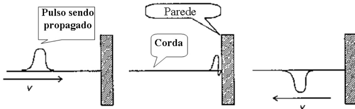
Figura 1 – Onda propagando-se com velocidade  $v$  em uma corda esticada. Note que há reflexão da onda ao encontrar a parede, na extremidade oposta de onde foi gerada.
