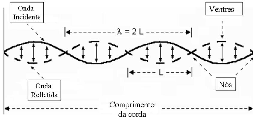
Figura 2 – Onda estacionária em um experimento de uma corda vibrante de comprimento  $L$  presa a duas extremidades fixas. São mostradas as definições do comprimento de onda  $\lambda$ , nós, ventres e as ondas incidente e refletida.
