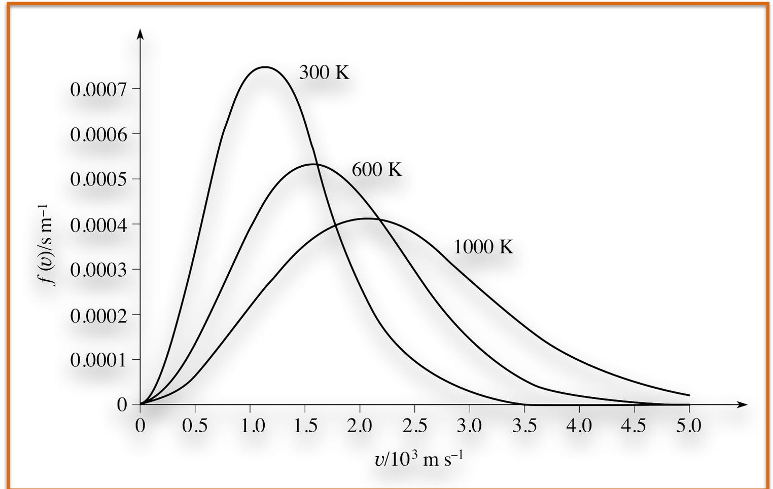
A função de distribuição de Maxwell-Boltzmann (velocidade) para uma amostra de gás a três temperaturas diferentes. A temperaturas mais elevadas, o pico da função de distribuição torna-se menor, mais amplo, e ocorre a uma velocidade maior
