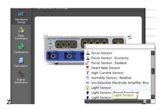
4. Clique na primeira das portas do sensor de rotação e escolha a opção *Rotary Motion Sensor*. Clique no ícone altera a opção Resolution para *High: 1440 counts per revolution*.
