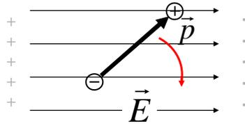
Qual a energia para rodar 180° um momento de dipolo elétrico?
