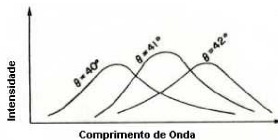
Figura 1 .A intensidade das ondas eletromagnéticas em função do comprimento de onda para três ângulos(medidos na direção oposta ao sol), observada somente com certas condições meteorológicas.
