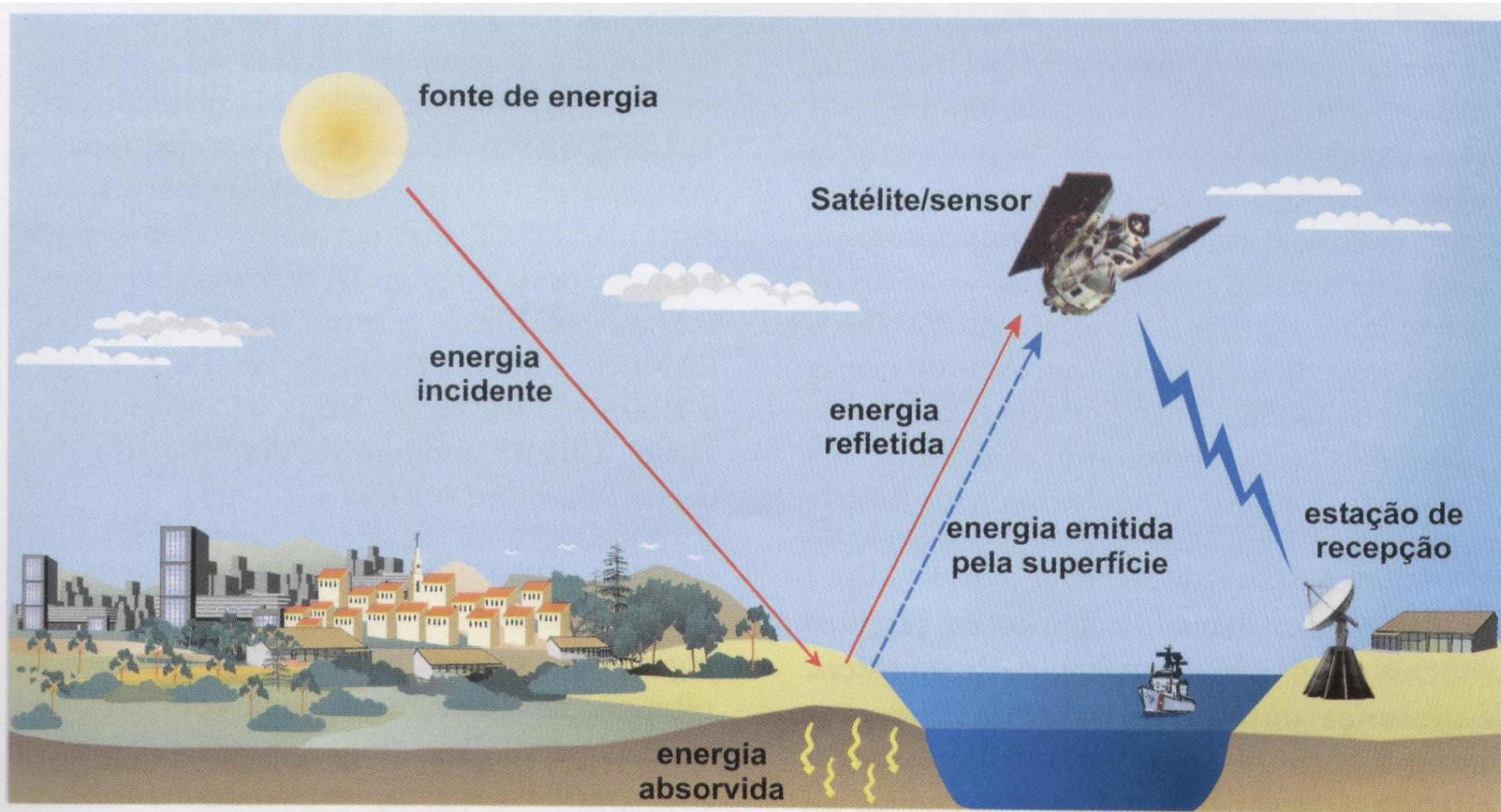
**Fig. 1.1** Obtenção de imagens por sensoriamento remoto
